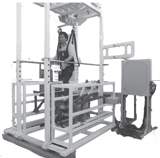
รูปที่ ๑ แสดงการฝึกเดินโดยใช้เครื่อง TU gait trainer สามารถปรับความเร็วได้ ๕ - ๕๐ ก้าว/นาที ลักษณะการเดินจะเป็นแบบการเดินบนพื้นราบ
