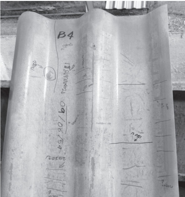
รูปที่ ๘ ตัวอย่าง B4 เป็นกระเบื้องซีเมนต์เส้นใยแผ่น ลอน (ผลิตภัณฑ์ทดแทน) ไม่มีสี เกิดรอยแตกร้าว หลายรอย ตามแนวยาวและแนวขวางทั้งแผ่น เมื่อผ่านการทดสอบ ๑๒ รอบ
